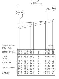
RETAINING WALL - LONGITUDINAL SECTION
