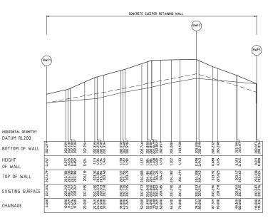
RETAINING WALL - LONGITUDINAL SECTION
