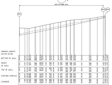
RETAINING WALL - LONGITUDINAL SECTION HORIZONTAL SCALE 1:500 @ A1
