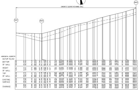
RETAINING WALL - LONGITUDINAL SECTION
