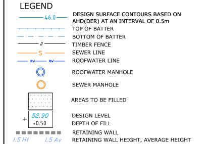
COMPACTION OF FILL IN ACCORDANCE WITH AS3798-2007 UNDER LEVEL 1 SUPERVISION.
